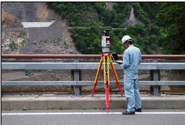
写真1. 災害現場における地形測量の様子
