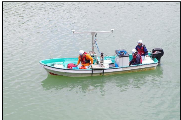
写真2. マルチビーム測深システムを使用した ダム堆砂量の調査状況
