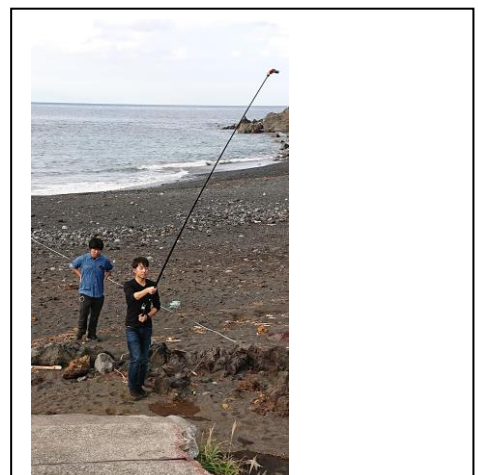
長谷川ゼミ： 伊豆大島の北西端にある浜で，ポールカメラを使った撮影をしています．数百枚の写真を撮影し，これらを元に写真測量から地形図を作成します．
