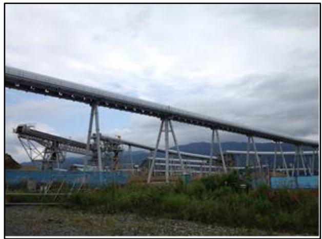
写真 4. かさ上げ事業のため設置されたコンベアー
